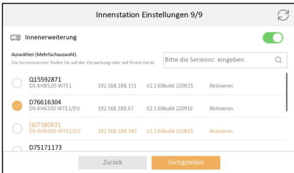
Wählen Sie in diesem optionalen Einrichtungsschritt im Netzwerk verfügbare Innenstationen aus der Geräteliste aus, welche der aktuellen Hauptinnenstation als Nebeninnenstationen (Innenerweiterung) hinzugefügt werden sollen.
