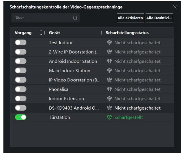
Bei aktivierter Scharfschaltung werden alle Ereignismeldung wie zum Beispiel Bewegungserkennung an die Software übertragen. Ist die Option deaktiviert, empfängt der Remote-Client (z.B.: iVMS-4200) keine Ereignismeldung.
