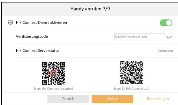
Verbinden Sie hier die Innenstation (nicht mit einer Einstellung **Innenerweiterung** möglich) mit dem Hik-Connect Dienst, um einen Zugriff über Ihr Smartphone zu ermöglichen.
