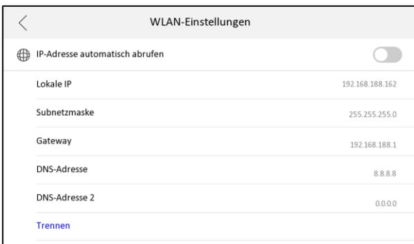
Durch Antippen des Listeneintrages eines ausgewählten WLAN-Netzwerkes, können Sie manuell die IP-Konfiguration vornehmen und über Trennen das WLAN-Netzwerk wieder verlassen.
