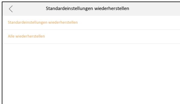
**Standardeinstellungen wiederherstellen:** alle benutzerdefinierten Einstellungen der Türstation (bis auf Netzwerk) werden zurückgesetzt. Das Gerät bleibt aktiviert.
