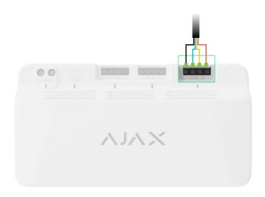
7. Schließen Sie die Drähte an die LineSupply-Eingangsklemmen gemäß der untenstehenden Abbildung an. Stellen Sie sicher, dass die Polarität und Reihenfolge der Leiterverbindungen richtig ist. Befestigen Sie das Kabel sicher an den Anschlüssen.
