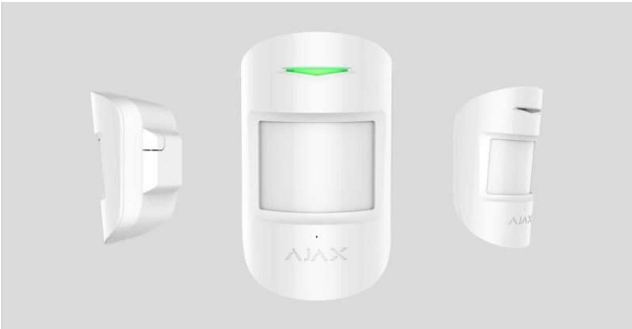
**CombiProtect** ist ein Gerät, das einen drahtlosen Bewegungsmelder mit einem Sichtwinkel von 88,5° und einem Abstand von bis zu 12 Metern sowie einen Glasbruchmelder mit einem Abstand von bis zu 9 Metern kombiniert. Es kann Tiere ignorieren und erkennt eine Person innerhalb der Schutzzone vom ersten Schritt an. Der Melder kann bis zu 5 Jahre mit einer vorinstallierten Batterie betrieben werden und wird innerhalb von Gebäuden eingesetzt.
