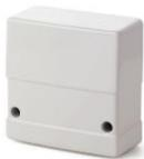
L'émetteur de contrôle distant GMXS5 est utilisé pour tester et évaluer entièrement une installation à l'aide de détecteur multiples en simulant des signaux d'attaque. Il est monté sur l'objet surveillé et est ainsi séparé du détecteur sismique. Si les détecteurs sismiques sont correctement espacés et configurés, le test est concluant et une alarme est déclenchée. Ainsi, l'installation dans son ensemble peut être vérifiée.
