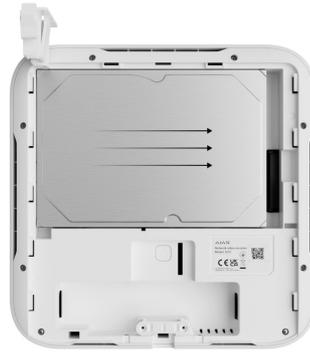
5. Schließen Sie die Festplattenverriegelung.
