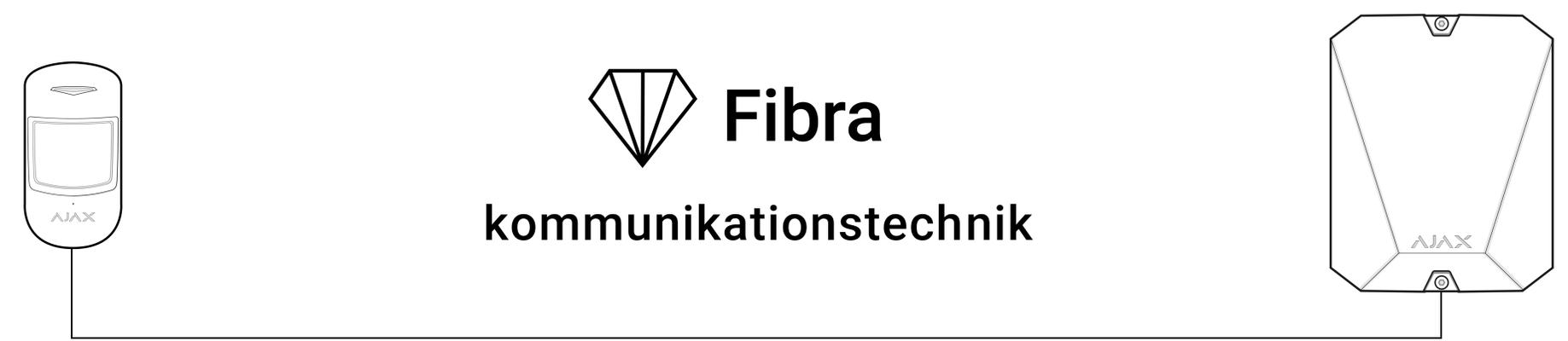
**Fibra** ist ein **Zwei-Wege-Protokoll**, das eine schnelle und sichere Kommunikation zwischen Hubs und Geräten über eine Kabelverbindung gewährleistet. Fibra basiert auf einer Bus-Technik und liefert sofort umfangreiche Alarmdaten: Sicherheitsunternehmen und Benutzer wissen, welcher Melder, wann und wo ausgelöst wurde.
