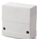
Der Fern-Prüfsender GMXS5 dient der vollständigen Überprüfung und Bewertung einer Installation mit mehreren Meldern mithilfe der Simulation von Angriffssignalen. Er wird getrennt vom Körperschallmelder auf das zu überwachende Objekt montiert. Wenn die Körperschallmelder im richtigen Abstand und mit den korrekten Einstellungen montiert sind, wird das Prüfsignal erkannt und ein Alarm ausgelöst. Deshalb kann die gesamte Installation überprüft werden.
