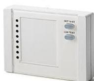
Das Alarmanzeigemodul GMYA7-A ermöglicht eine Erweiterung des Alarmanzeigesystems GMYA7-AS. Insgesamt unterstützt ein System 7 Anzeigemodule, wobei jedes mit bis zu 8 Körperschallmeldern verbunden werden kann.
