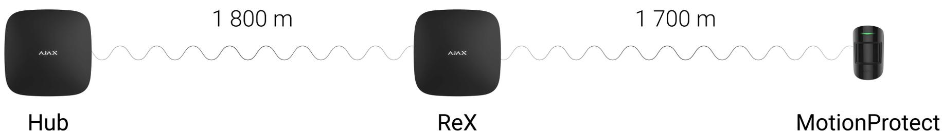
La portée maximale de la communication radio avec les dispositifs connectés est de 1 700 mètres sans obstacles. Jusqu'à 5 prolongateurs de portée peuvent être connectés au système de sécurité Ajax. Il permet d'utiliser les produits Ajax pour la protection des installations à grande échelle. Quel que soit le nombre de dispositifs connectés au ReX, les alarmes sont délivrées en 0,3 seconde.
